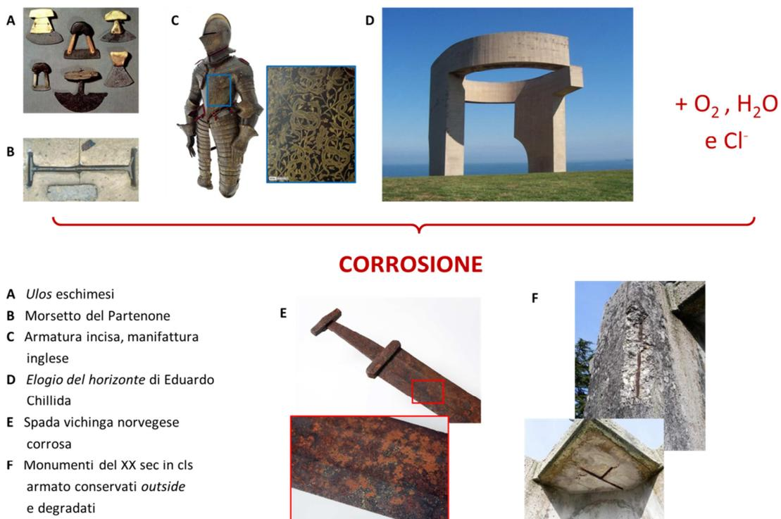
**Figura 1:** Corrosione di manufatti in e contenenti acciaio, in presenza di ossigeno (O<sub>2</sub>), acqua (H<sub>2</sub>O) e ioni cloruro (Cl<sup>-</sup>).
